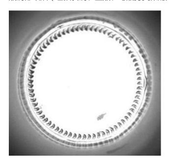
瓶口部分的检测内容是除了检测瓶身外观上那些缺陷类型外,还需要检测微裂纹、缺口、破口、圆口不齐等缺陷;
